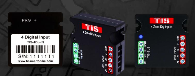
Este pequeño módulo se usa para conectar diferentes tipos de sensores digitales, que por lo general trabajan en estructura NO/NC (Normal Abierto/Normal Cerrado), en la red inteligente del hogar. Para comprender esto mejor, imaginemos un detector de humo. Detecta el humo, pero sólo puede hacer eso. Así que necesita de un conector que enlace este sensor a otros dispositivos inteligentes para que las acciones necesarias puedan llevarse a cabo.
